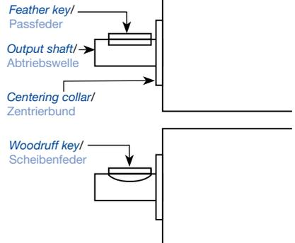
An der Abtriebswelle können weitere mechanische Übertragungselemente montiert sein.
